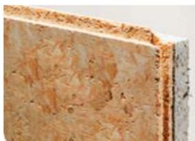
**Le panneau Biofib'acoustix OSB est constitué de 2 panneaux** : un à base de papier recyclé et d'anas de lin, contrecollé à une dalle constituée de plaquettes de bois orientées OSB/3 poncé, de 18 mm d'épaisseur, rainurée / bouvetée. La colle utilisée est à base d'acétate de polyvinyle ne contenant pas de formaldéhyde.
